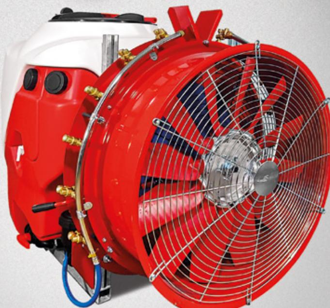
ATOMIZER with rear suction; ATOMISEUR à aspiration arrière;
